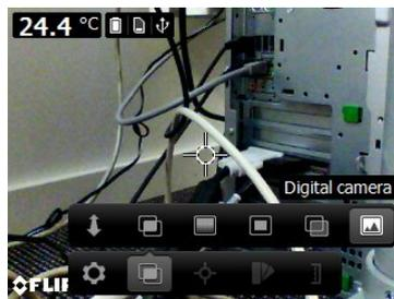
Pour afficher une bonne fusion d'image (modes *MSX*, *Picture-in-picture* et *Fusion thermique*), la caméra doit effectuer des ajustements afin de compenser la légère différence de position entre l'objectif de la caméra numérique et l'objectif infrarouge. Pour ajuster l'image avec précision, la caméra a besoin de la distance d'alignement (distance par rapport à l'objet).
